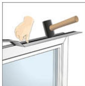
Afb. 9 Het geschikte profiel met rubberhamer aanbrengen.
